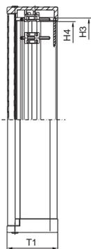
Монтажные вырезы для подсоединения несущего рычага CP 40, сталь
